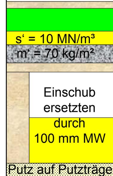
maximal "weiche" Trittschalldämmung kann real eingesetzt werden
