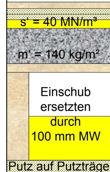
**Achtung: Laborprüfungen mit "weicher" Trittschalldämmung, keine Verlegung Parkett/Fliesen (Format) möglich, "harte" TSD ca.-5 dB**
