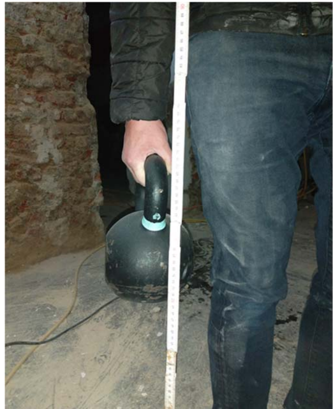
Abbildung 8: Fallhöhe der Gewichte
