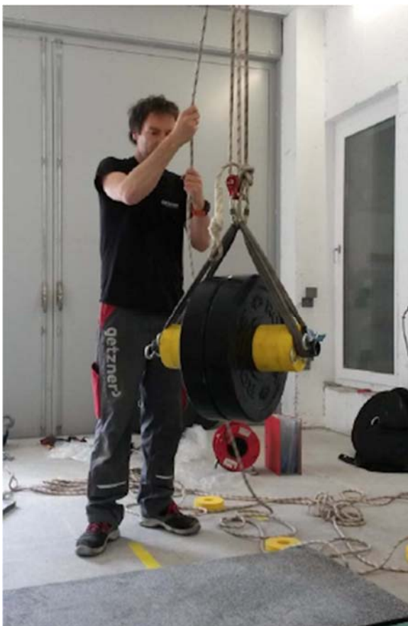
Abbildung 2: Gewicht zur Erzeugung hoher Fallenergie
