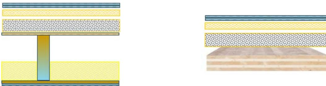
**Abbildung 7:** Rohdecken mit Trockenestrich mit unterschiedlichen Trittschalldämmplatten auf Schüttung im Prüfstand, Trockenestrich aus 2 x 10 mm Gipsfaserplatten,  $m' = 25 \text{ kg/m}^2$
