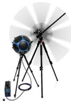
**Abbildung 15:** Ko-lokierte Anordnung der omnidirektionalen Schallquelle und des rotierenden linearen Arrays.
