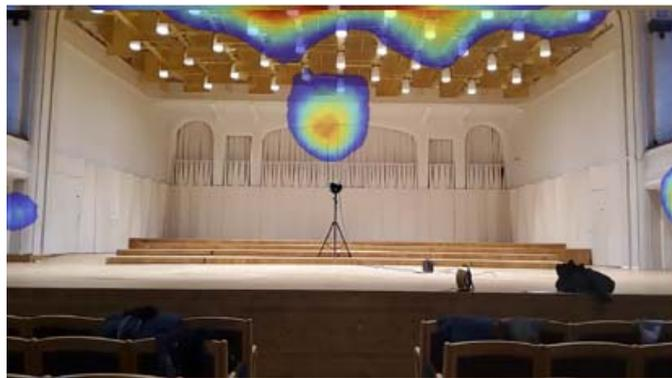
**Abbildung 20:** Primäre Reflexionen, die am Beobachtungspunkt lokalisiert werden. Der ausgewählte Frequenzbereich liegt bei 250 Hz – 3,1 kHz mit einem Dynamikumfang von 2 dB.
