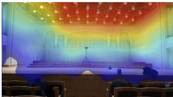
**Abbildung 21.** Kritische Reflexionen, die am Beobachtungspunkt lokalisiert werden. Der ausgewählte Frequenzbereich liegt bei 250 Hz – 3,1 kHz mit einem Dynamikumfang von 6 dB.
