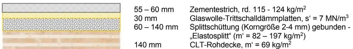
**Abbildung 9:** 140 mm Brettsperrholz-Rohdecke mit Zementestrich über Mineralwolle-Trittschalldämmplatte auf „Elastosplitt-Schüttung“
