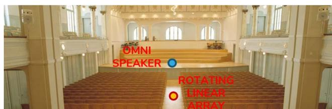
**Abbildung 18:** Anordnung der omnidirektionalen Quelle und des rotierenden linearen Arrays für die Analyse der Schallausbreitung vom Bühnenbereich zu einem Beobachtungspunkt im Zuschauerraum.
