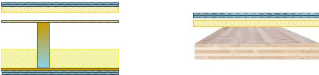
**Abbildung 6:** Rohdecken mit Trockenestrich mit unterschiedlichen Trittschalldämmplatten im Prüfstand
