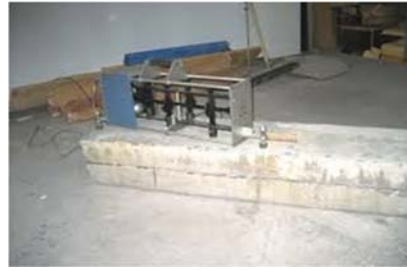
Abbildung 1: Unterschiedliche Messverfahren: Treppenprüfstand der MA39, 1991 (links), Prüfungen eines Herstellers mittels gestapelter Betonfertigteilmassen (rechts)
