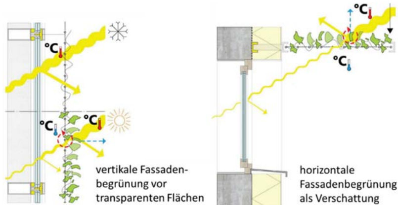
Abb. 6: Einfluss vertikaler & horizontaler Fassadenbegrünungen auf die solaren Wärmegewinne (Quelle: Nicole Pfoser, Gebäude Begrünung Energie, 2013)
