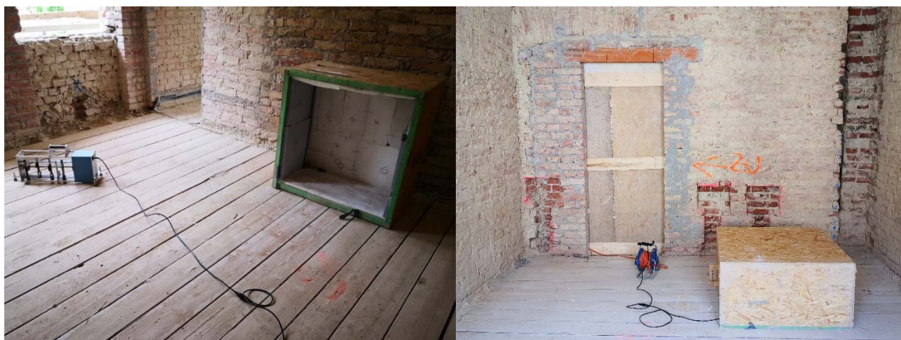
Abbildung 4: Die Luftschallausbreitung am Hammerwerk wurde mit einer Schallhaube begrenzt.
