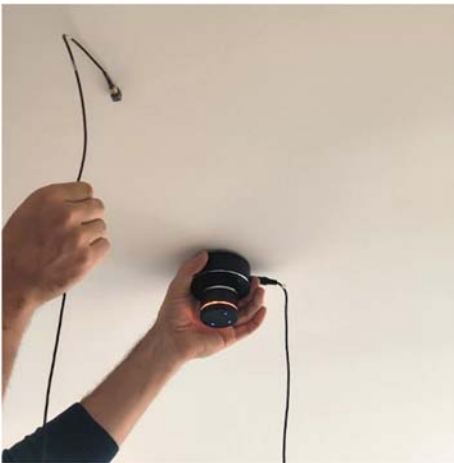
Abbildung 3: Messung des Schnellepegels an der Unterdecke mittels Beschleunigungsaufnehmer und Resonanzlautsprecher als Körperschallquelle
